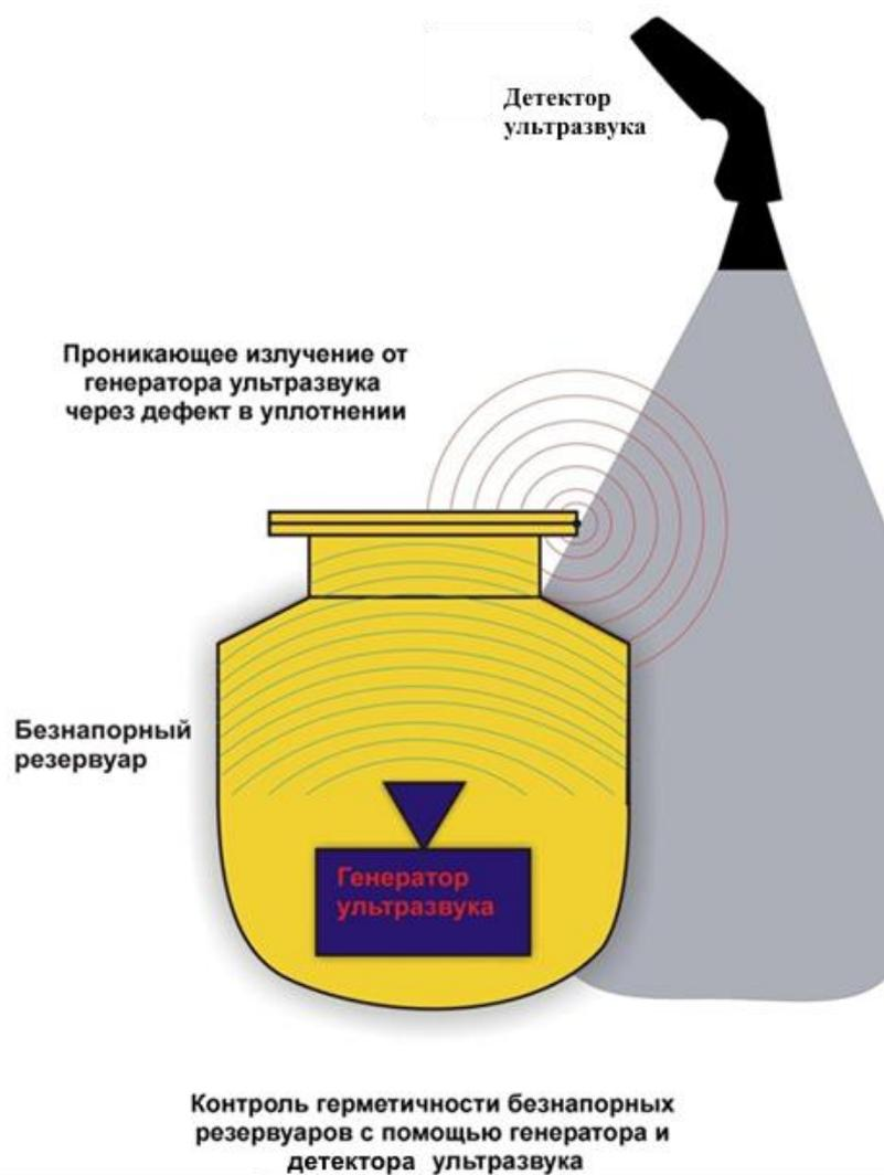
Принцип обнаружения негерметичности с помощью генератора и детектора ультразвука.
